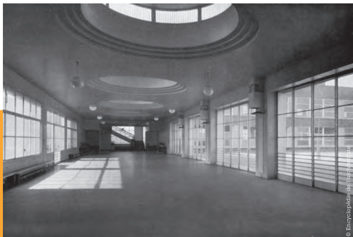
Les préaux bénéficient de lumière zénithale. Les grandes baies vitrées peuvent coulisser électriquement afin de s'ouvrir totalement sur la cour.
